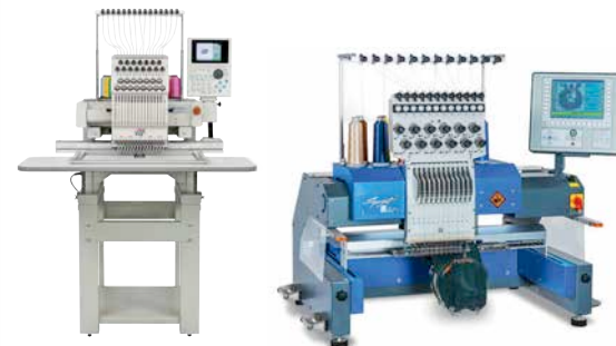
单头绣花机: 田岛公司的平绣机(左)和蔡斯克公司的自由臂绣花机(右)
